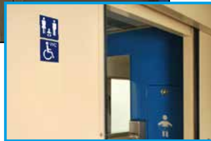
Handikappanpassad toa, 60x60 mm, 1 st Placeras 185cm över golv.
