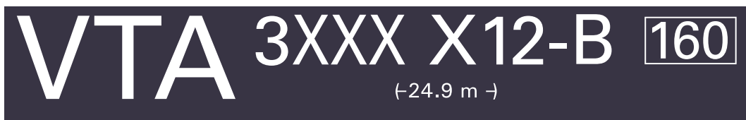
Långbalksmärkning B-vagn Texthöjder: VTA 100 mm; X12-A 60 mm; "24.9" 25 mm.
