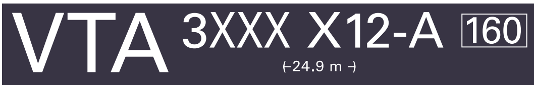
Långbalksmärkning A-vagn. Exempel VTA 3214 x12-A [160] Texthöjder: VTA 100 mm; X12-A 60 mm; "24.9" 25 mm.
